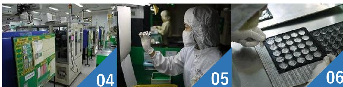
光学部品は使用用途上、ゴミなどの異物付着や成形品内へ混ざること避けるため、クリーンルーム内で生産します（写真 04）。成形エリア 1,500m<sup>2</sup>では金銭機械用プリズム（写真 05）、車載用光学部品、カメラ用レンズ（写真 06）などを生産。組立エリア 3,000m<sup>2</sup>ではプロジェクターレンズユニットの組立、医療用カメラレンズユニットを組立しています。
