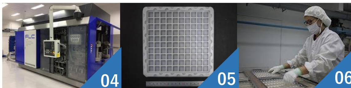
単発真空成形機と高速連続真空圧空成形機（写真04）の両方を導入し、従来の製品梱包用トレイ（写真05）は一般環境で単発真空成形機を使用し生産、クリーン度や物量を要求される電子部品梱包用トレイなどはクリーンルーム内（写真06）で高速連続真空圧空成形機にて生産することでお客様が安心してご使用いただける品質、物量を担保しています。
